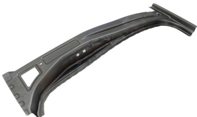
Figura 10.10 Coluna B produzida por estampagem a quente de aços ao boro [18].
