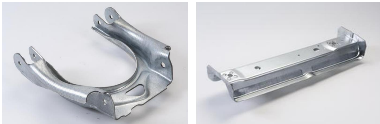
Figura 9.7 Travessa do assento em HR460560T-FB-GI Extragal ® de 1,8 mm de espessura (esquerda) e braço de suspensão em Extragal ® HR460560T-FB-GI de 4 mm de espessura [2].
